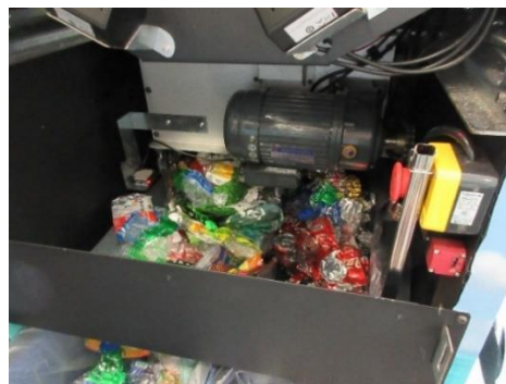
▲ 回收機把收集的鋁罐和塑膠樽壓縮
