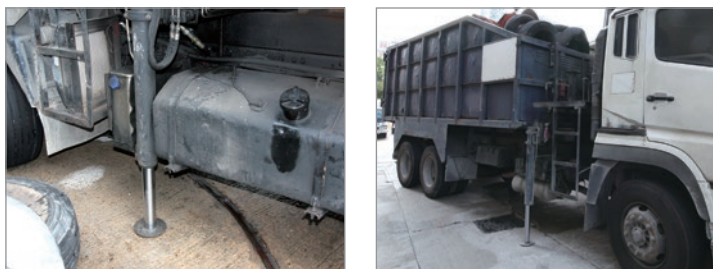
車輛兩邊的安全裝置，防止車輛傾側
