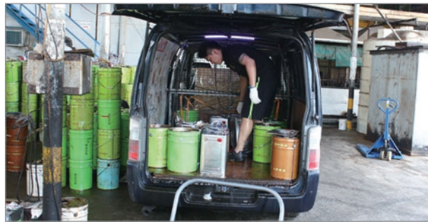
員工以索帶固定車內的廢置食用油收集桶
