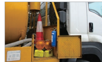
運輸車輛內設有滅火設備
