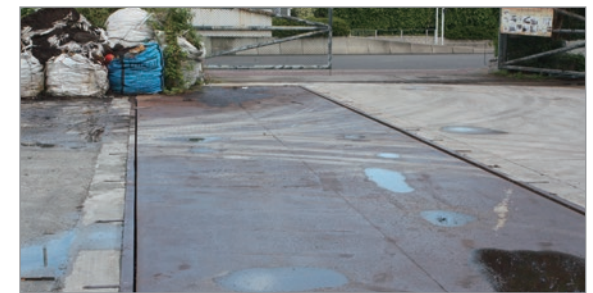
車磅以量度卸貨前和卸貨後的重量
