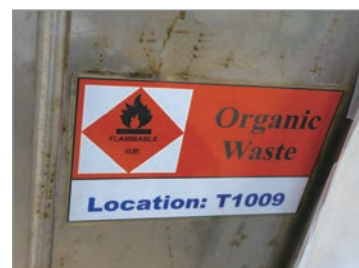
易燃物品存放在鐵箱內，並貼有標籤
