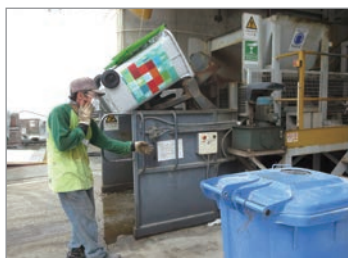
破碎機工作時僅施工人員可以接近
