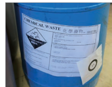
為腐蝕物品貼上標籤及警告
