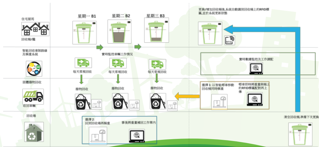
智能稱重試驗的流程(較適用於固定時間回收及即時稱重)
